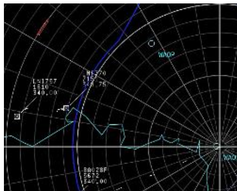
Gambar 4.12 Tes Transponder Tidak Berada Pada Posisinya
